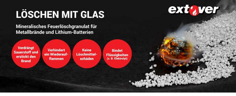
Durch Abdecken der Brandlast mit Extover® wird Sauerstoff verdrängt und vom Brennstoff getrennt. Wie Glas schmilzt Extover® ab einer gewissen Temperatur. Das Granulat nimmt dabei viel Wärme in Form von Schmelzenergie auf, kühlt damit den Brand ab und bildet gleichzeitig eine undurchlässige Hülle über der Brandlast. Eine Reaktion mit Sauerstoff wird effektiv verhindert.
