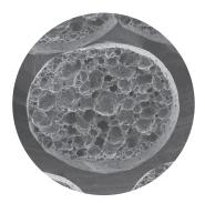
Multizellulares, expandiertes Granulat aus Recyclingglas mit geschlossenen Poren.
