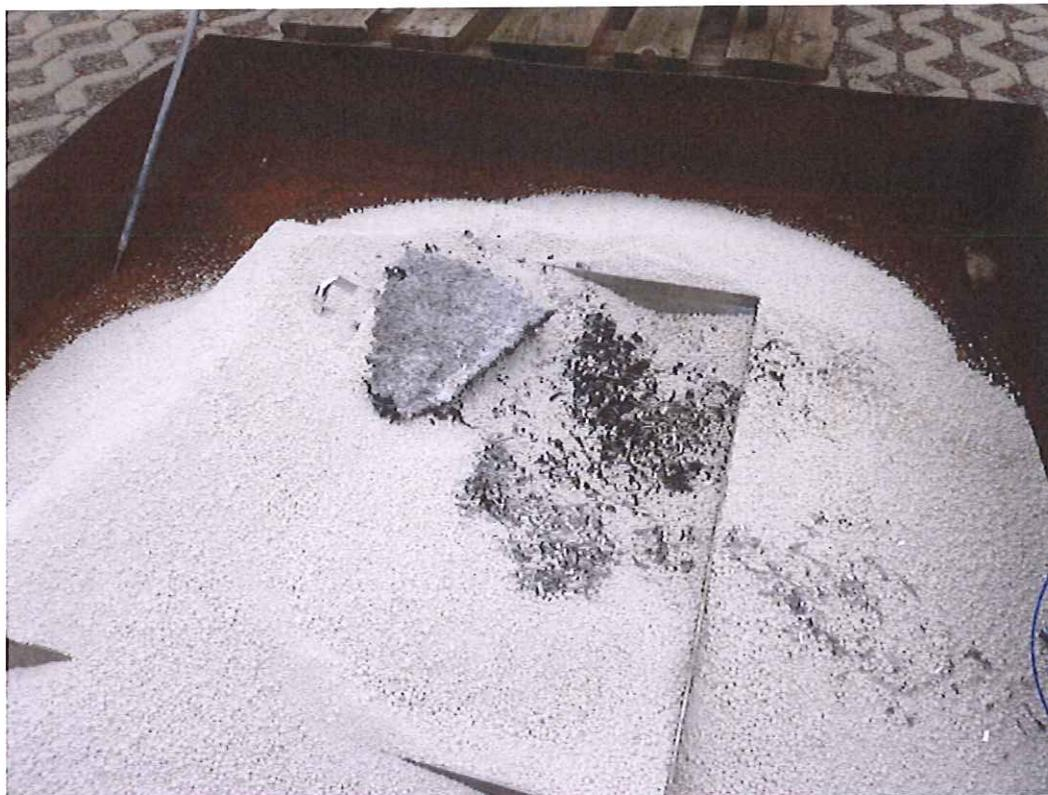
Abb. 10: Zustand nach Entfernung von EXTOVER am Prüfobjekt Magnesium mit Resten von unverbranntem Material
