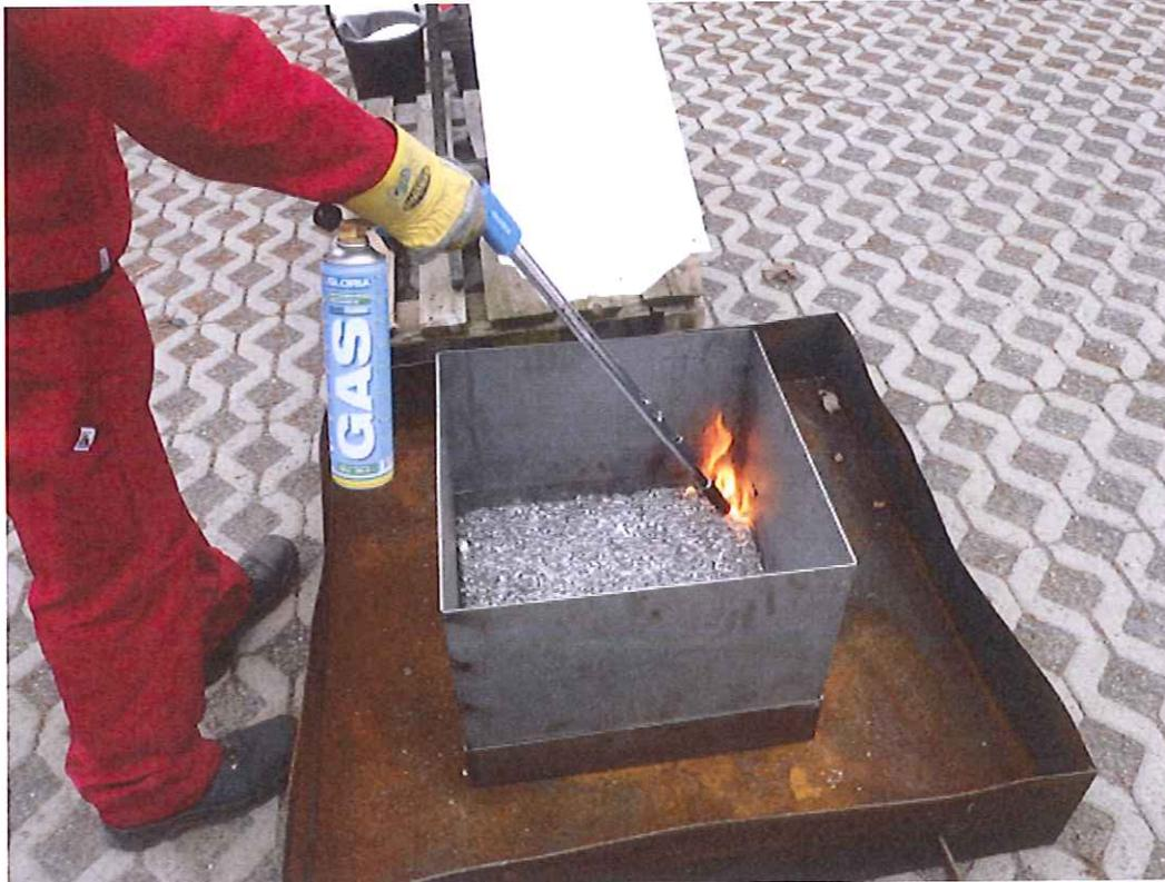
Abb. 5: Zünden des Versuchs mit Magnesium
