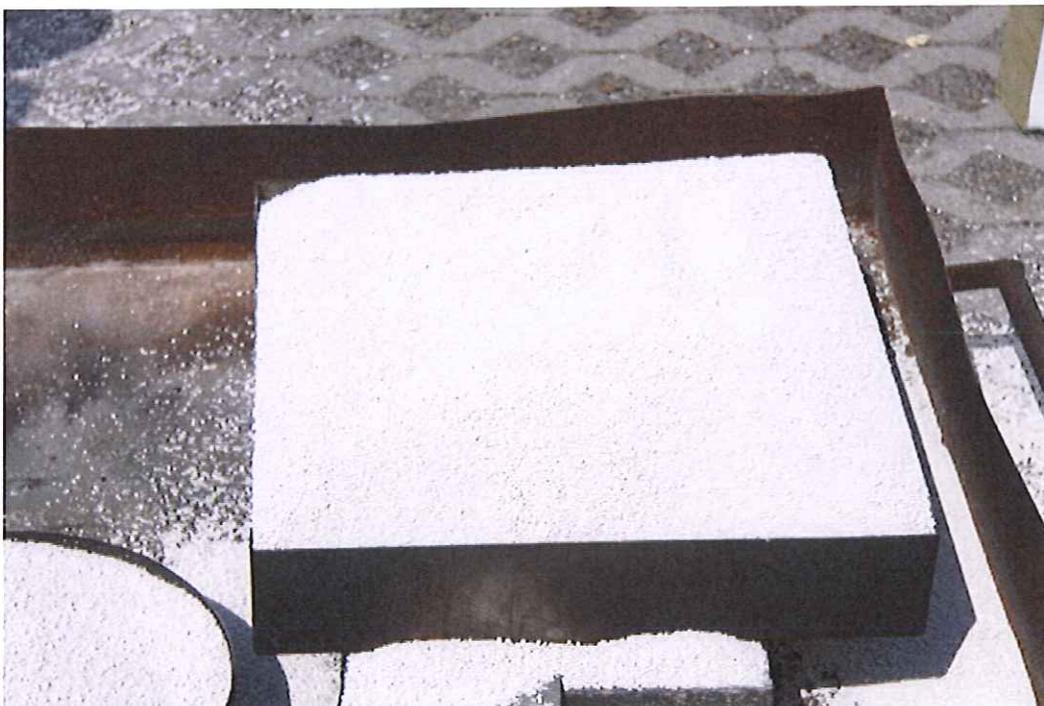
Abb. 16: Prüfobjekt vollständig abgedeckt und gelöscht
