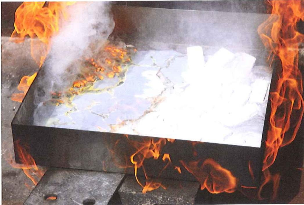
Abb. 13: Zustand nach Zündung, Natrium teilweise geschmolzen und brennend
