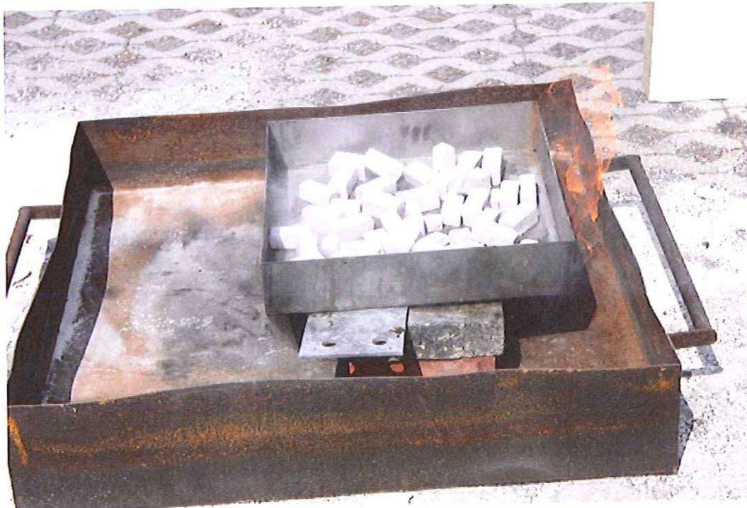
Abb. 11: Allgemeiner Versuchsaufbau Brandversuch Natrium
