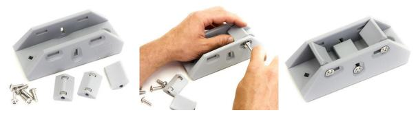
5. Um den WheelFix an das Rad anzupassen, wird als erstes der untere Halter in der benötigten Höhe fixiert. Anschließend wird das Rad hineingestellt und die beiden seitlichen Halter dagegen gedrückt. Jetzt können die Schrauben leicht angezogen werden. Nach dem das Rad wieder entnommen wurde können die Schrauben fest angezogen werden. Dabei sollten die seitlichen Halter fest gehalten werden damit sie sich nicht verdrehen.
