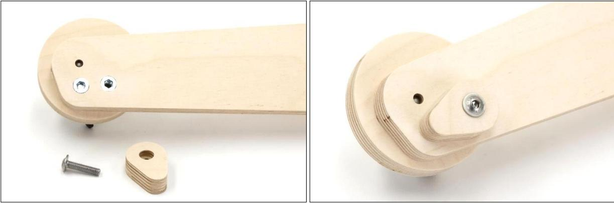
7. Jetzt kann der Anschlag und das Zeigerelement vorbereitet werden. Die Kunststoffteile etwas von der Unterseite anschleifen und mit etwas Kleber in den vorgesehenen Aussparungen einlegen.
