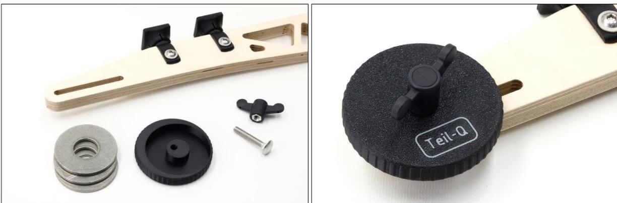
20. Jetzt können Kopfelement und Schwinge miteinander Verbunden werden. Dazu wird eine M6 x 25 Zylinderkopfschraube, eine große M6 Scheibe und zwei kleine M6 Scheiben benötigt. Die Zylinderschraube wird durch das Kugellager gesteckt. Anschließend wird von der Gegenseite zuerst die beiden kleinen Scheiben und anschließend die große Scheibe aufgesteckt. Das Ganze wird dann so wie dargestellt zusammen montiert.
