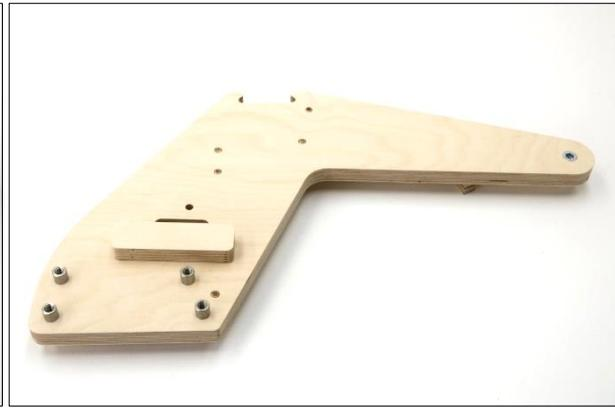
**13. Jetzt werden die vorher eingesetzten Gewindehülsen noch mit den M6 x 12 Flanschkopfschrauben von der Gegenseite gesichert.**
