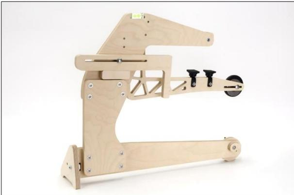
23. Abschließend werden die beiden Seiten der Schwerpunktwaage noch mit dem Verbinder und den verbleibenden zwei Flügelschrauben zusammen montiert. Die Schwerpunktwaage ist nun einsatzbereit.
