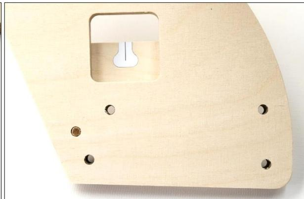
12. Jetzt werden die vorher eingesetzten 30 mm langen Holzdübel durchgeschlagen. Dazu etwas Restmaterial als Unterlage verwenden. Die Stifte sollen bündig mit der Oberfläche abschließen. Falls die Schwerpunktwaage auf dem Küchentisch aufgebaut wird auch unbedingt aufpassen, dass die Holzstifte keine Markierungen reindrücken. Dann lieber etwas mehr unterlegen.. 😊
